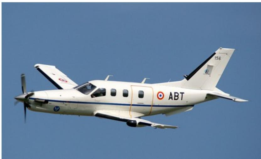
Le **TBM 700** est un avion d'affaires français produit par Socata. Il s'agit d'un monomoteur turbopropulsé à aile basse conçu par Socata et Mooney.
